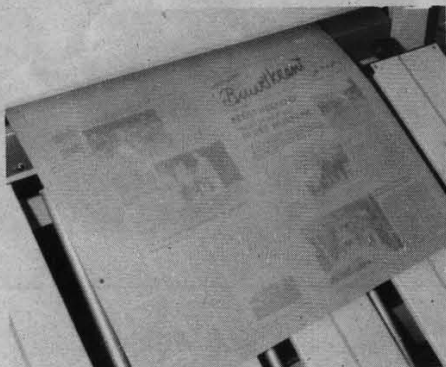
De ontwikkelde plaat is klaar voor de drukpers.
