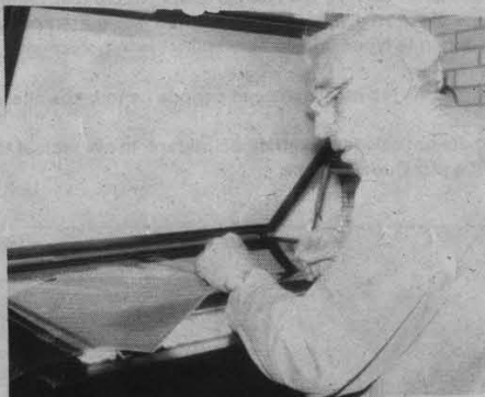
In de kontaktkast wordt deze film belicht.
