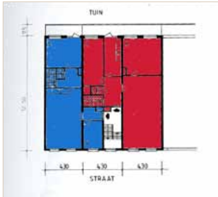
Woningen in een gedeelte van de Bajonetstraat (eerste bouwgeneratie) na de renovatie eind jaren zeventig. (meer over de Bajonetstraat op pagina 57-59)
